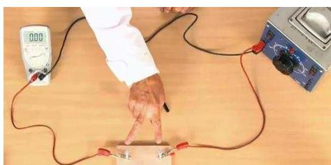
أ. برای این منظور، **مداری متوازن** مطابق شکل آماده می‌شود و گرافیت (مغز مداد) در آن قرار می‌گیرد.
