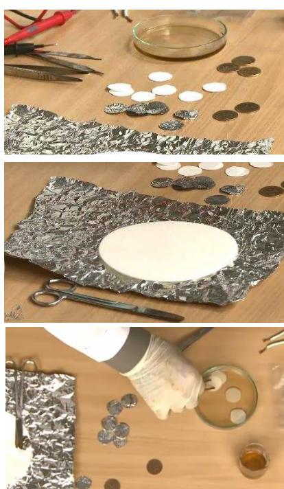
❖ سکه های مسی (۵ عدد در این آزمایش) را برای شتیشوی چربی و دیگر آلدگی ها، در محلول شستشو که مخلوطی از سرکه و نمک است، مدتی قرار می دهیم. اگر ورق مسی  $0.5$  میلیمتری به جای سکه به کار روند نتیجه بهتری به دست می آید.
