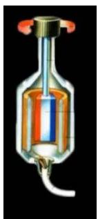
ژنراتور یا دینام تشکیل می‌شود از یک سیم پیچ که می‌تواند ثابت یا متغیر باشد. شکل روبرو دینام دوچرخه است که سیم پیچ آن ثابت و آهن ربا متحرک است. در آرمیچر معمولاً آهن ربا ساکن است و سیم پیچ می‌چرخد. اگر آرمیچر را به باتری متصل کنیم می‌چرخد چنانچه آن را بچرخانیم برق تولید می‌کند.
