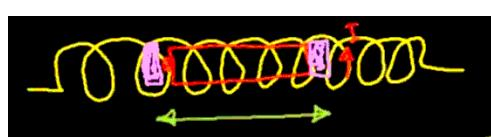
(۱) اگر یک سیم پیچ را در نظر بگیریم که از آن جریان برق عبور می کند و سیم پیچ را آهنربا می کند باتری که به دو سور آن آهنربای قوی نئودیمیوم متصل است و در داخل سیم پیچ قرار می گیرد باعث عبور
