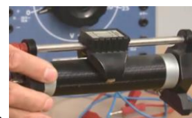
رئوستا یا مقاومت متغیر، معمولاً به طور متوالی در مدار قرار می‌گیرد
