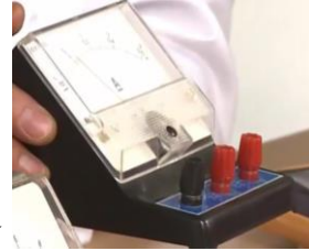
آمپرسنج و میلی آمپرسنج، برای اندازه گیری جریان الکتریکی
