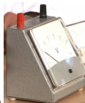
ولت‌سنج، برای اندازه‌گیری اختلاف پتانسیل
