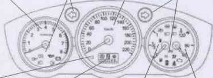
دما سنج آب، چراغ فشار، نشانگر میزان سوخت، چراغ، صفحه نمایش چرخ، آمپر نمایش مسافت طی شده، دکل انتخاب کیلومتر شمار، مسافت دمای بالای آب، مقدار حداقل میزان سوخت، مسافت سفر وضعیت دنده در گیربکس اتوماتیک، سفر و عملکرد تنظیم نور پشت زمینه
